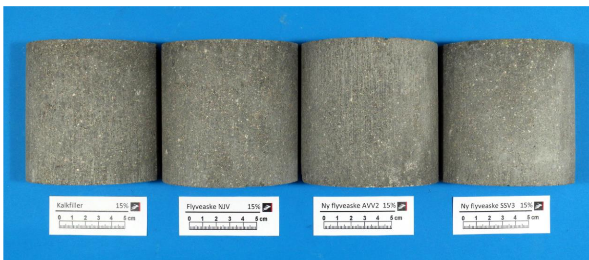
Billede 4. Tørre prøveemner ved en alder af 40 døgn. 15% indhold af filler.
