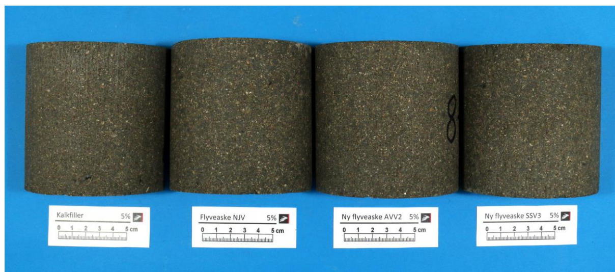
Billede 5. Våde prøveemner ved en alder af 40 døgn. 5% indhold af filler.
