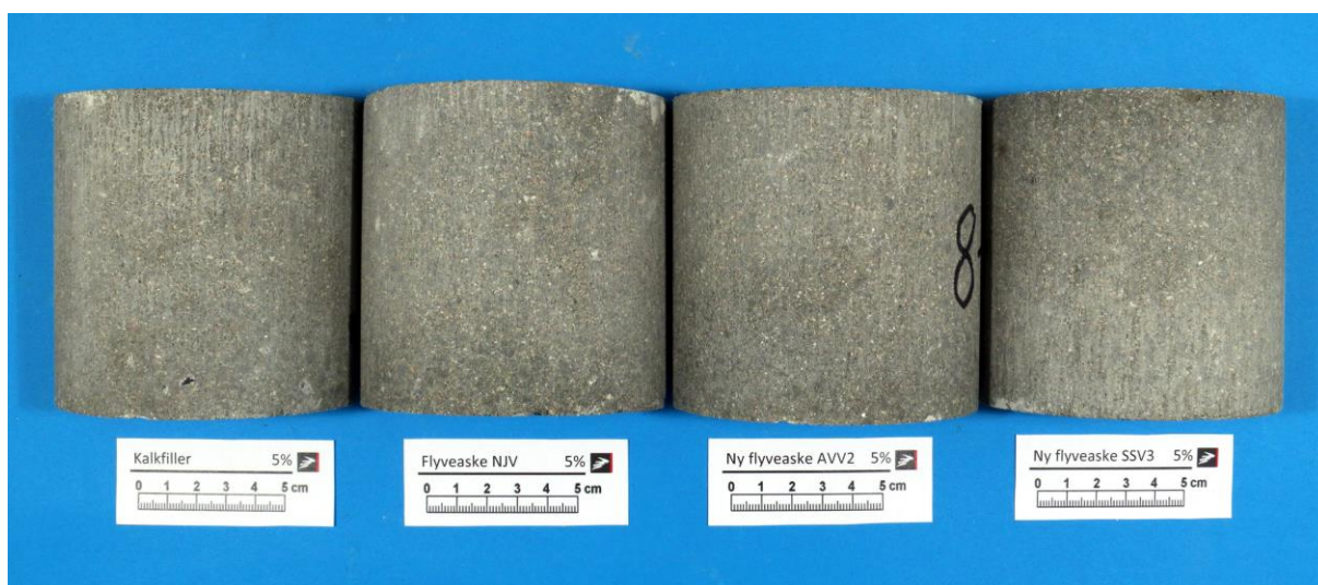
Billede 3. Tørre prøveemner ved en alder af 40 døgn. 5% indhold af filler.
