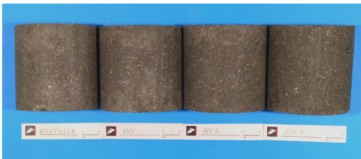
Billede 2. Våde prøveemner ved en alder af 2 døgn. 10% indhold af filler.
